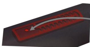
Contrôle qualité de l'orifice de sortie par caméra haute vitesse pour de meilleures performances.
